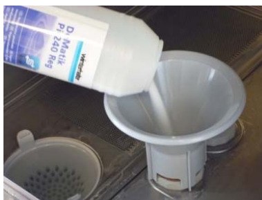
Włożyć lejek do otworu wlewowego. Wsypać butelkę (=1,5 kg) sproszkowanego środka regeneracyjnego DeMatik Pi-240 Reg .
